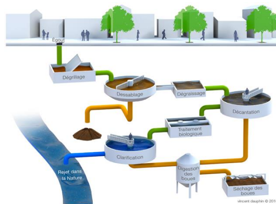
Figure 3 : Schéma du processus de la station d'épuration
