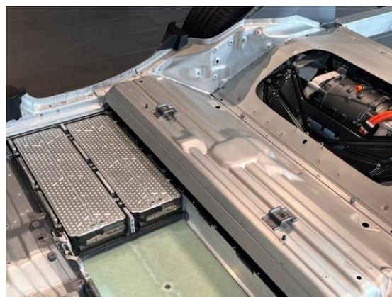
*Exemple d'un bloc de propulsion pour voitures électriques, ici le bloc de Lucid Motors (batterie, moteur et gestionnaire de batterie)*
