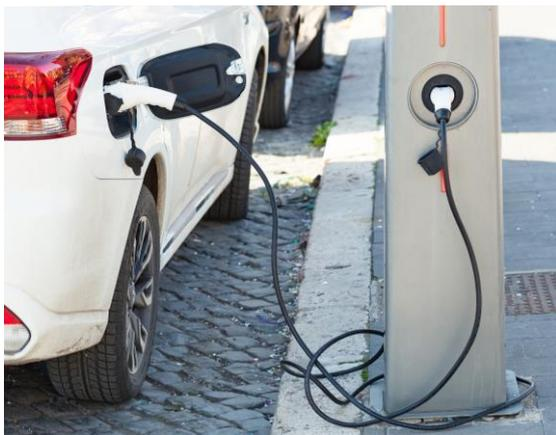
*Voiture branchée sur un port de charge rapide, ce qui est mauvais pour la durée de vie de la batterie.*
